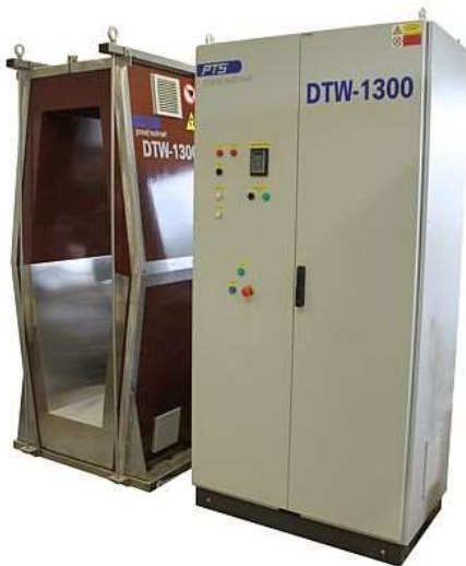
Démagnétiseur de roues pour le ferroviaire
